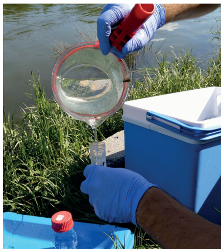
Probenahme für die Metallanalyse
