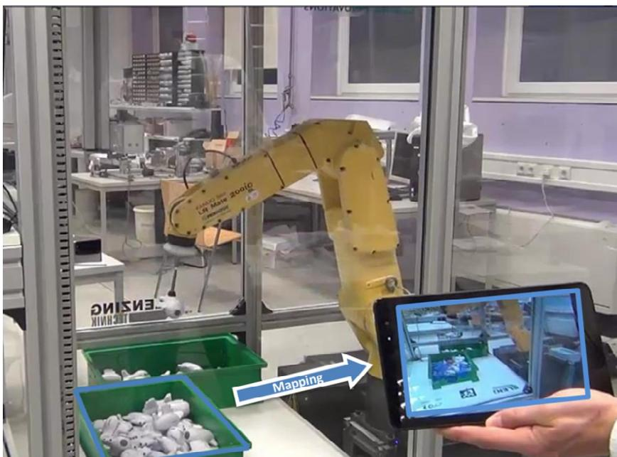
**Abbildung 2: Augmented Reality am Beispiel der erkannten Objekte, die im Live-Bild am Tablett überlagert visualisiert werden. Das erforderliche Mapping der Koordinatensysteme wurde mittels Mark gelöst.**
