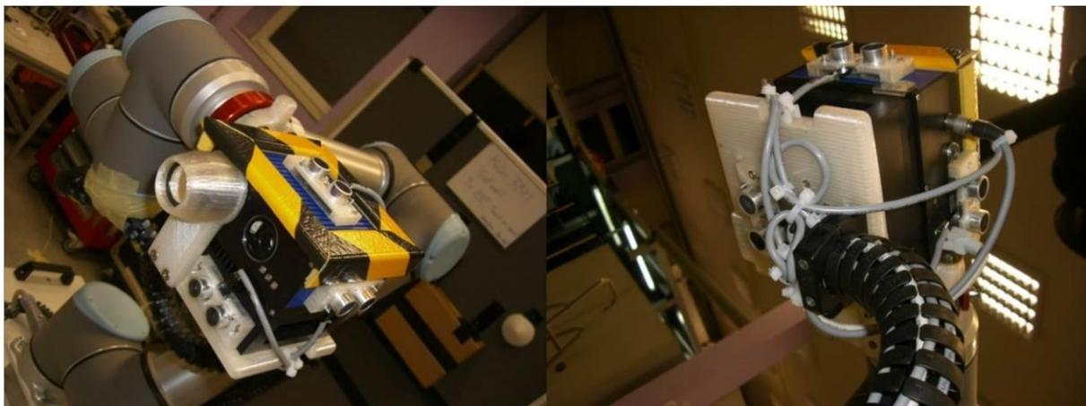
**Abbildung 5: Montage der Sensorik am Werkzeug des Roboters**
